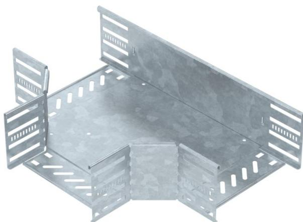
T-Stück zum Erstellen einer horizontalen Abzweigung, Formteil für rast- und schraubbare Kabelrinnen Seitenhöhe 110 mm. Schraubenlose Montage mit Doppelklemmen oder Schraubverbindung mit Flachrundschauben FRS und Kombimuttern M6. Einsetzbar im Innen- und Außenbereich. Befestigungsmaterial muss separat bestellt werden.
