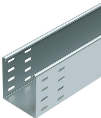
SKS = Schweres Kabelrinnen-System in Seitenhöhe 110 mm. Mit Verbinderlochung an beiden Kabelrinnenenden. Längsverbindung mit Längsverbinder RLVA 110 FS. Verbinder müssen separat bestellt werden.
