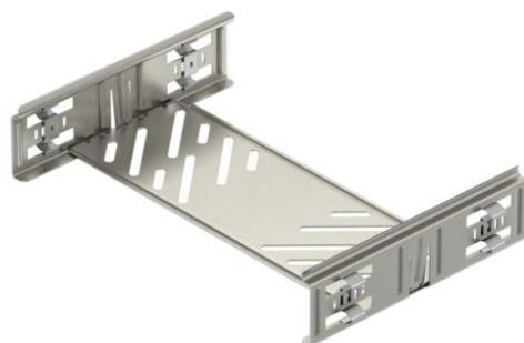
Kabelrinnenverbinder mit Schnellbefestigung für die schraubenlose Verbindung von gelochten Kabelrinnen mit der Seitenhöhe 60 mm. Durch die optimierte Bauform kann der Verbinder zur Herstellung von Radien und als Längenausgleichsstück bei großen Temperaturschwankungen eingesetzt werden.
