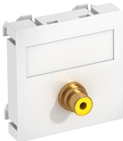
Multimediaträger mit einer Cinch Anschlussbuchse für Composite Video, Kabelauslass gerade, mit Beschriftungsfeld, Cinch Buchse (RCA) mit Lötanschluss, Farbkodierung gelb. Trägerplatte mit Rastbefestigung, geeignet für den waagerechten und senkrechten Einbau in die Systemumgebung.
