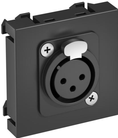
Multimediaträger mit einer XLR-Anschlussbuchse, Kabelauslass gerade, ohne Beschriftungsfeld, XLR-Buchse 3-polig mit Lötanschluss. Trägerplatte mit Rastbefestigung, geeignet für den waagerechten und senkrechten Einbau in die Systemumgebung.
