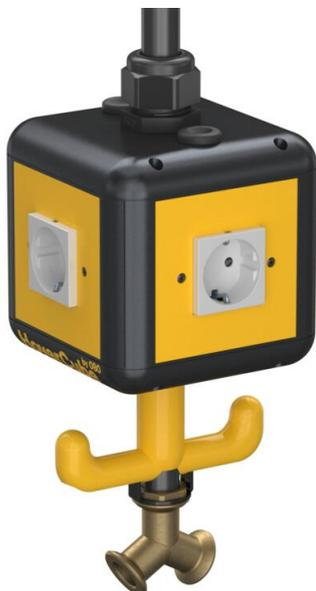
Gehäuse bestückt und vorverdrahtet, mit 1 m Rohr 1/2" und Anschluss für Druckluftschlauch 13 x 3,5 mm und 2-Wege-Verteiler 1/2", mit Aufhängeöse, Griffhaken und 4 Abdeckplatten. Bestückt wie folgt: 4 x 1fach Schutzkontakt-Steckdosen 16 A/250 V mit erhöhtem Berührungsschutz, auf zwei Wechselstromkreise vorverdrahtet, Anschluss über 2 x Klemmen 3-polig, mit Trennwand zur Stromeistrennung.
