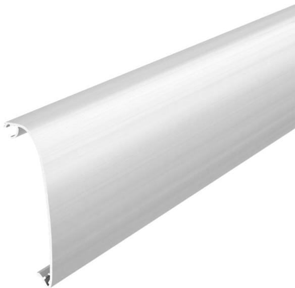
Kanalabdeckung zur Erstellung eines Design-Geräteeinbaukanals der Serie GAD. Designausführung "Soft" zur vollständigen Abdeckung der Systemöffnung und der Schalt- und Steckgeräte. Die Oberteiladapter GAD OTA sind zwingend erforderlich und sollten im max. Abstand von 50 cm auf der Kanalstrecke eingeplant werden. Zwischen den Kanalabdeckungen muss ein Distanzstück GAD OTD gesetzt werden.
