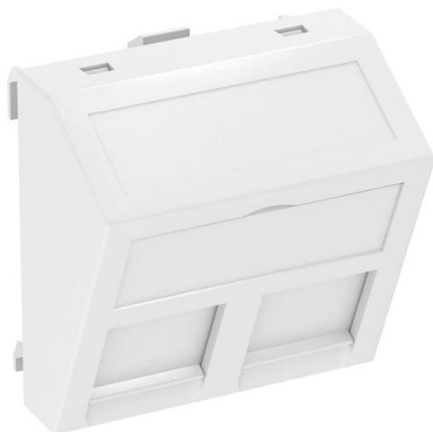
Datentechnikträger mit schrägem Auslass und Verschlusschieber zur Aufnahme von zwei Datentechnik-Anschlussmodulen mit RJ45-Buchse. Die Rastbefestigung eignet sich für den waagerechten und senkrechten Einbau in die Systemumgebung. Typ F hat eine spezielle Modulaufnahme und ist für eine indirekte Befestigung der Daten-Anschlussmodule in der Montageöffnung ausgelegt. Datentechnikträger Typ F ist für die Aufnahme der nachfolgenden Daten-Anschlussmodule geeignet: Avaya/Systemax: M-Serie.
