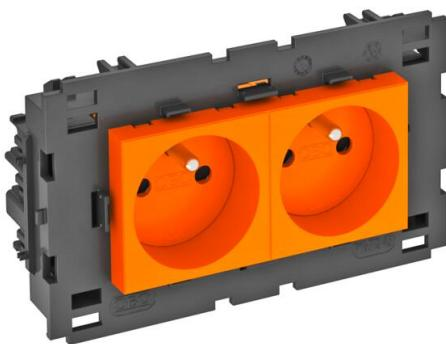
Erdungsstift-Steckdose mit seitlichem Anschluss 2-fach 0°, mit erhöhtem Berührungsschutz, mit Steckklemmen, 2-polig, 16 A, 250 V~, mit Verbindungsklemmen nach IEC 60884-1, geeignet für den Einbau in Geräteeinbau-Kanalsysteme Rapid 80.
