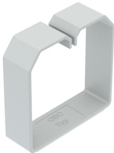
Kabelhalteklammer für LKV-Verdrahtungskanäle. Die Kabelhalteklammer umfasst alle im Kanal installierten Leitungen und verhindert das Herausfallen beim Abnehmen der Oberteile. Mit Klebeband an der Unterseite zur Montage. Zum einfachen Verlegen der Kabel.
