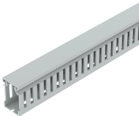
Halogenfreier Verdrahtungskanal inkl. Oberteil und Bodenlochung zur waagerechten und senkrechten Verlegung elektrischer Kabel und Leitungen im Schaltschrank. Mit doppelseitigen Klebeband am Kanalboden als Montagehilfe. Ausführung als metrischer Kanal. Das Ausbrechen der Stege erfolgt werkzeuglos. Sonderlängen auf Anfrage.
