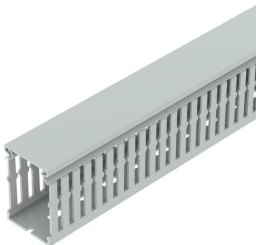
Halogenfreier Verdrahtungskanal inkl. Oberteil und Bodenlochung zur waagerechten und senkrechten Verlegung elektrischer Kabel und Leitungen im Schaltschrank. Mit doppelseitigen Klebeband am Kanalboden als Montagehilfe. Ausführung als metrischer Kanal. Das Ausbrechen der Stege erfolgt werkzeuglos. Sonderlängen auf Anfrage.
