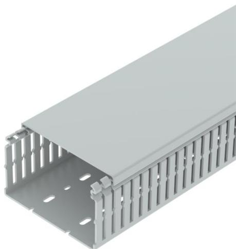
Halogenfreier Verdrahtungskanal nach DIN EN 50085-2-3 inkl. Oberteil und Bodenlochung zur waagerechten und senkrechten Verlegung elektrischer Kabel und Leitungen im Schaltschrank. Ausführung als DIN-Kanal. Das Ausbrechen der Stege erfolgt werkzeuglos. Bodenbündiges Ausführen ist durch Sollbruchstellen möglich. Verjüngungen in den Seitenschlitz verhindern das Herausfallen der Leitungen. Geprüft nach DIN EN 50085-2-3. Sonderlängen auf Anfrage.
