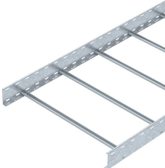
Kabelleiter in Seitenhöhe 110 mm mit eingeschweißten, nach oben offenen C30-Profil Sprossen. Eingerollter Seitenholm zur Verstärkung und als Kantenschutz. Die Befestigung auf dem Ausleger erfolgt mit Klemmstücken Typ LKS 40. Das Schlitzmaß der Sprosse beträgt 16,5 mm, die passende Bügelschelle ist der Typ 2056.
