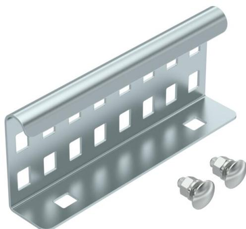
Längsverbinder als Außenverbinder zur Verbindung von Kabelleitern und Formteilen mit 60 mm Seitenhöhe und durchgängiger Holmlochung. Die Durchgängigkeit des Potentialausgleichs ist durch die Verschraubung sichergestellt.
