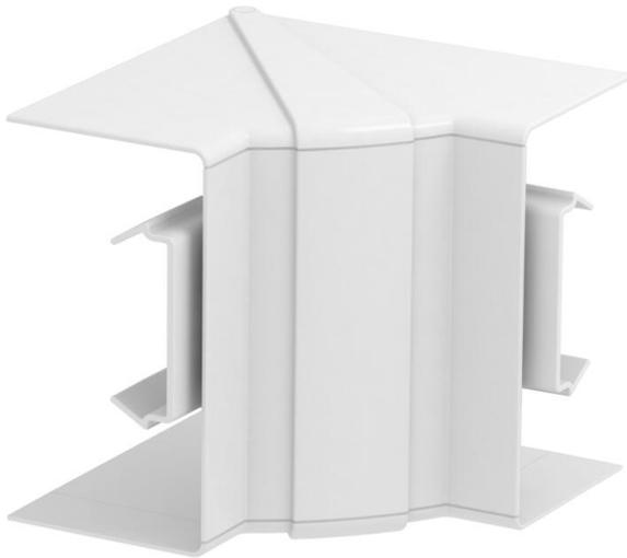
Inneneck-Haubenformteil aus halogenfreiem PC/ABS zur Richtungsänderung von Geräteeinbaukanälen Rapid 80 der Systeme GK, GKH, GS und GA. Die Formteile sind variabel von 85° - 95° verstellbar und einsetzbar für symmetrische und asymmetrische Kanäle.
