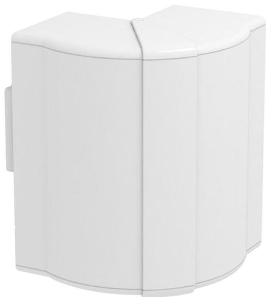
Außeneck-Haubenformteil aus halogenfreiem PC/ABS zur Richtungsänderung von Geräteeinbaukanälen Rapid 80 der Systeme GK, GKH, GS und GA. Die Formteile sind variabel von 80° - 100° verstellbar und einsetzbar für symmetrische und asymmetrische Kanäle.
