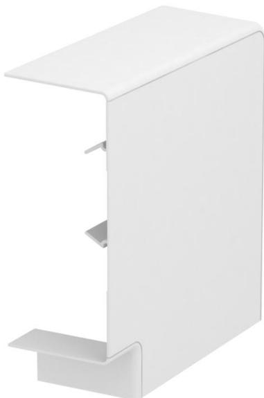
Flachwinkel-Haubenformteil aus halogenfreiem PC/ABS zur einfachen Erstellung einer steigenden oder fallenden 90° Richtungsänderung mit Geräteeinbaukanal der Serie Rapid 80 GK, GKH, GS und GA. Das Flachwinkel- Haubenformteil ist einsetzbar für symmetrische und asymmetrische Kanaltypen.
