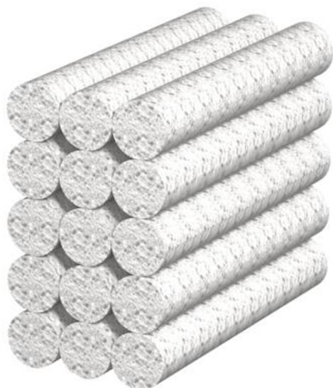
Die Schallschutzbarriere dient zur Minderung der Luftschall-Übertragung z. B. bei Führung des Kanalsystems durch Wanddurchbrüche zwischen zwei Büros. Die Schallschutzbarriere besteht aus Glaswolle, die im Lieferzustand einen Durchmesser von ca. 30 mm und eine Länge von ca. 300 mm hat. Das Material braucht bei der Montage nicht extrem komprimiert zu werden. Die Dämpfung beträgt ca. 40 dB.
