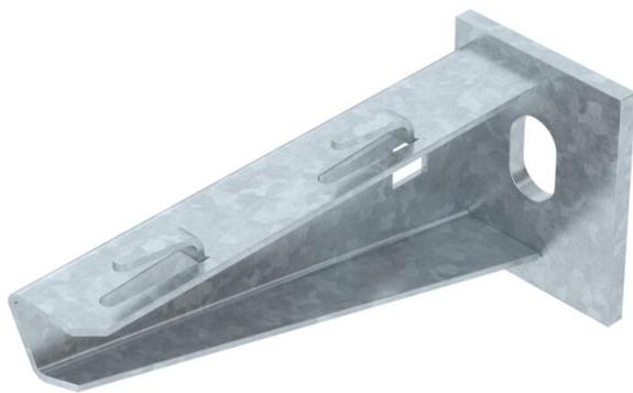
Leichter Wand- und Stielausleger mit angeschweißter Kopfplatte für die schraubenlose Gitterrinnenbefestigung. Befestigung des Auslegers am U-Stiel ab der Breite 400 mm mit Sechskantschraube durch beide Holme des Stiels. Bitte dazu die passenden Distanzstücke einsetzen.
