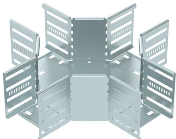
Kreuzung zum Erstellen einer horizontalen Abzweigung, Formteil für rast- und schraubbare Kabelrinnen Seitenhöhe 110 mm. Schraubenlose Montage mit Doppelklemmen oder Schraubverbindung mit Flachrundschräuben FRS und Kombimuttern M6. Einsetzbar im Innenbereich. Befestigungsmaterial muss separat bestellt werden.
