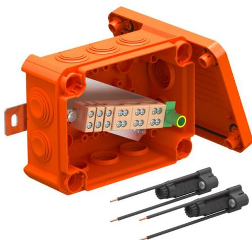
Kabelabzweigkasten mit zwei Sicherungshaltern und weichen Einsteckdichtungen. Ausreichender Verdrahtungsraum durch diagonal angeordnete Anschlusseinheit mit komplett vormontierten hochtemperaturbeständigen Keramikklammern. Grün-gelb gekennzeichnete Schutzleiterklemme. Befestigung an gut zugänglichen Außenlaschen. Zugelassen für Kabelanlagen mit elektrischem Funktionserhalt nach DIN 4102 Teil 12 mit den Klassen E30, E60 und E90. Keramikklammern wurden nach DIN EN 60998-2-1:2004 geprüft.
