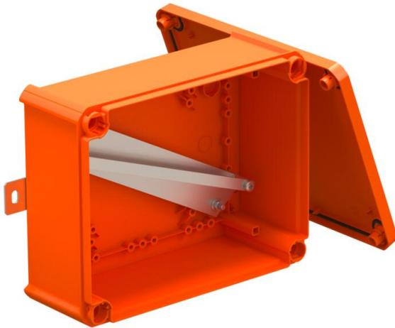
Unbestückter, geschlossener Verbindungs- oder Kabelabzweigkasten zur freien Konfektionierung mit Keramikklemmen und Kabelverschraubungen. Maß A gibt die verfügbare Tragschielenlänge für die Verdrahtungsklemmen an. Ausreichender Verdrahtungsraum durch diagonal angeordnete Tragschiene. Befestigung an gut zugänglichen Außenlaschen aus Edelstahl. Zugelassen für Kabelanlagen mit elektrischem Funktionserhalt nach DIN 4102 Teil12 mit den Klassen E30, E60 und E90.
