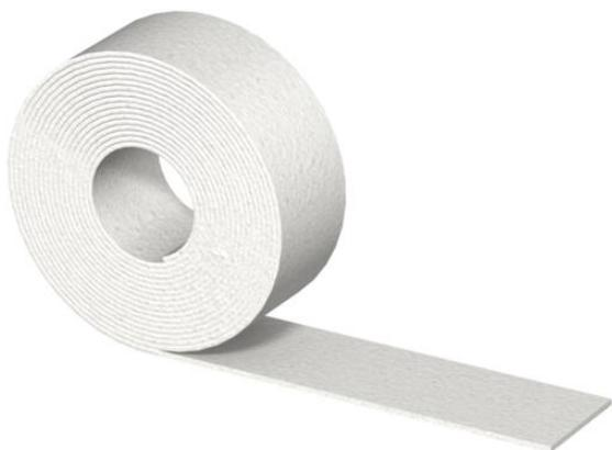
Selbstklebender Dichtungstreifen zur Montage in den Stoßfugen der einzelnen Kanalstücke und für die Abdichtung zwischen Unterteil und Deckel der Brandschutzkanäle PYROLINE® CON D PLC EI30 - EI60 und PYROLINE® CON S PLC EI30 - EI60.
