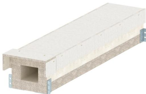
Brandschutzkanal aus wasser- und frostbeständigem Glasfaserleichtbeton der Baustoffklasse A1 gemäß EN 13501-1 zur brandsicheren Verlegung von Kabeln in Flucht- und Rettungswegen. Klassifizierung EI90 als Installationskanal gemäß EN 13501-2 auf Basis von Prüfungen gemäß EN 1366-5. Der Kanal verhindert bei einer Brandbelastung von innen (Kabelbrand) die Brandausbreitung von einem Brandabschnitt auf einen anderen.
