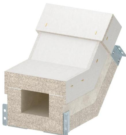
Vertikalbogen steigend für Brandschutzkanal PYROLINE® Con S EI90, Typ PLCS D090810 bestehend aus wasser- und frostbeständigem Glasfaserleichtbeton zur Herstellung von vertikalen Richtungsänderungen (45°) im Kanalverlauf. Fertig montierte Verbindungsbeschläge sorgen für eine schnelle Montage vor Ort, lose aufgelegte Deckel für eine schnelle Revision und Nachbelegung. Inklusive Verbindungsschrauben und Dichtungsstreifen.
