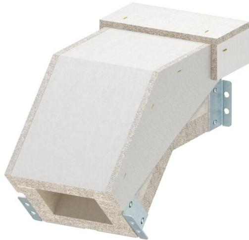
Vertikalbogen fallend für Brandschutzkanal PYROLINE® Con S EI60, Typ PLCS D060810 bestehend aus wasser- und frostbeständigem Glasfaserleichtbeton zur Herstellung von vertikalen Richtungsänderungen (45°) im Kanalverlauf. Fertig montierte Verbindungsbeschläge sorgen für eine schnelle Montage vor Ort, lose aufgelegte Deckel für eine schnelle Revision und Nachbelegung. Inklusive Verbindungsschrauben und Dichtungsstreifen.
