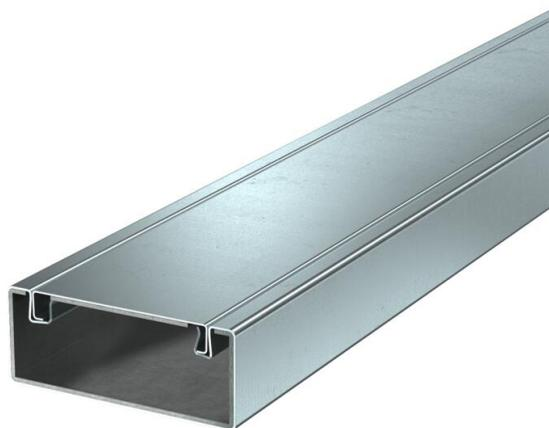
Installationskanal aus Metall mit intumeszierendem Brandschutzgewebe zur brandsicheren Verlegung von Kabeln. Klassifiziert als Installationskanal EI30, EI60 und EI90 gemäß EN 13501-2, geprüft nach EN 1366-5. Der Kanal verhindert über den klassifizierten Zeitraum die Brandweiterleitung und schützt vor den Auswirkungen eines Kabelbrandes.
