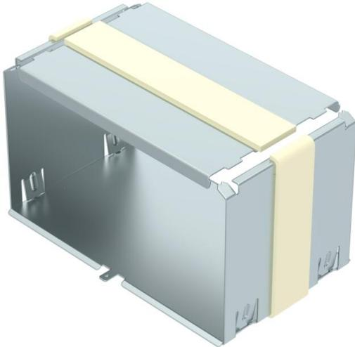
Stoßstellenverbinder-Set bestehend aus Verbinder für Kanalunterteil und Deckelunterstützung. Mit integrierter Dichtung zur werkzeuglosen Verbindung des Installationskanals PYROLINE® Rapid PLM und Formteilen. Ermöglicht einen durchgängigen Anschluss der Schutzleiter.
