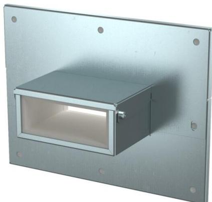
Wandanschlusskragen, 4-seitig mit integrierter Dichtung für Installationskanal PYROLINE® Rapid PLM. Zur Montage im Bereich von Wand- und Deckenanschlüssen sowie Wanddurchführungen. Auch als 3-seitiger Wandanschlusskragen bei direkter Wand- oder Deckenmontage des Kanals einsetzbar. Kein elektrischer Funktionserhalt nach DIN 4102 Teil 12!
