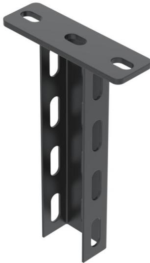
Hängestiel (U-Profil) in der Abmessung 50 x 30 mm mit angeschweißter Kopfplatte. Zur Befestigung an waagerechten Betondecken und Stahlträgern. Pulverbeschichtet in tiefschwarz (RAL 9005). Ab der Auslegerbreite 400mm oder der Montage des Auslegers am Ende des Hängestiels empfiehlt sich der Einsatz des Distanzstücks Typ DSK 25.
