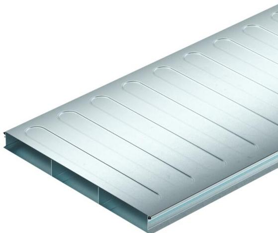
Unterflurkanal (2-teilig) zur Verlegung von Kabeln und Leitungen in estrichüberdeckten Unterflur-Systemen nach EN 50085-2-2. Abnehmbarer und durchgängig aufrastbarer Kanaldeckel. Mit Trennsteg im Kanalunterteil. Maximale Belastbarkeit bis 1,5 kN.
