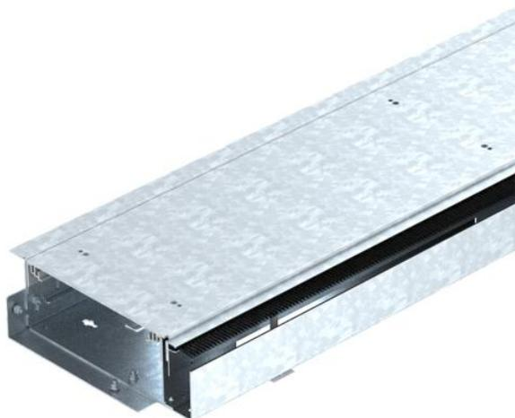
Montagefertige Kanaleinheit zur Leitungsführung und zum Geräteeinbau, bestehend aus einem Kanalunterteil mit zwei Deckeln und einer höhenverstellbaren Bürstenleiste. Im Lieferumfang enthalten sind zwei Deckelstoßdichtungen und ein Verbinder. Zur Höheneinstellung werden sechs Nivelliereinheiten benötigt. Bis maximal 5 kN belastbar. Die Kanaleinheit kann mit ein verstellbaren Bodenbelagsanlageprofil zur Estrichabgrenzung in Bereichen von Türleibungen und vor Heizkörpernischen ergänzt werden.
