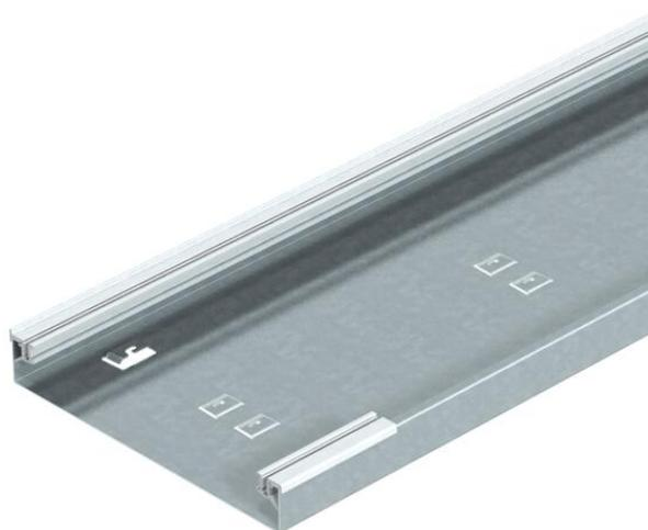
Aufflur-Installationskanal-Unterteil, 1-zügig, für Blind-/Montagedeckel mit einseitiger Abschrägung, mit aufsteckbaren Aluminium-Seitenprofilen zum Auflagern und Befestigen der Kanaldeckel, Bodenwanne mit Haltetaschen für max. 2 einsteckbare, selbstkontaktierende Trennstege und Prägung für Schutzleiteranschlusswinkel. Kanalhöhe geeignet zum Einbau von Geräteeinsätzen der Nenngröße 2.
