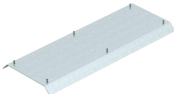
Afflur-Blindeckel zum Abdecken des Aflur-Abzweigkanals AIK/A, passend zu den Kanalunterteilen AIK/U. Der Kanaldeckel wird in den AI-Seitenprofilen des Kanalunterteils festgeschraubt. Die Deckelschräge überragt das Kanalunterteil im 45°-Winkel.
