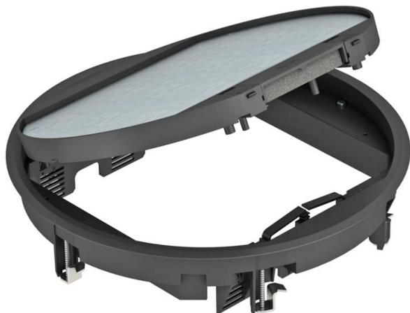
Geräteinsatz mit Rastschieber für bis zu 12 Modul 45-Einzelgeräte in 3 Universalträger UT4, Einsatz in Kanalsystemen und Systemböden im Innenbereich. Bodenbelagausparung im Klappdeckel 5 mm, bei Bedarf auch einstellbar auf 3, 10 oder 12 mm. Bis zu 9 Installationsgeräte mit 50er Zentralplatte einsetzbar.
