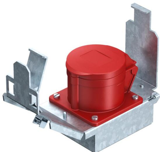
Geräteträger der Nenngröße 2 mit einer CEE-Steckverbindung 16 A zum Einbau in Geräteeinsätze und Kassetten der Nenngröße 2, 4, 6 und R7. Geräteträger mit Schutzgehäuse und Zugentlastung. Benötigte Mindesteinbautiefe: 190 mm bei Verwendung eines Geradeaus-Steckers und 160 mm bei Verwendung eines Winkelsteckers.
