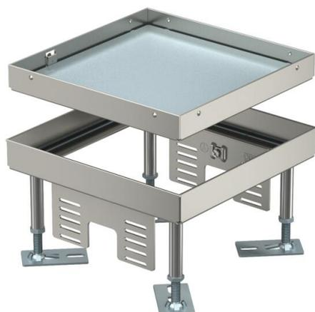
Nivellierbare quadratische Kassette Schwerlast "blind" in Nenngröße 4 für die Herstellung einer Revisionsöffnung. Einbau in Kanalsystemen, Doppel- und Hohlböden in trocken oder nass gepflegten Fußböden im Innenbereich. Belastungsklasse 1 bis 10 kN. Nur für glatte Bodenbeläge geeignet. Für den Einbau von 2 Universalträgern UT3 für 4 Einzel-Installationsgeräte mit Tragering/Tragebügel oder 6 Modul 45®-Geräte. Es können 2 Abdeckplatten APMT2 installiert werden.
