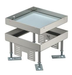
Nivellierbare quadratische Kassette Schwerlast "blind" in Nenngröße 4 für die Herstellung einer Revisionsöffnung. Einbau in Kanalsystemen, Doppel- und Hohlböden in trocken oder nass gepflegten Fußböden im Innenbereich. Belastungsklasse 1 bis 10 kN. Nur für glatte Bodenbeläge geeignet. Für den Einbau von 2 Universalträgern UT3 für 4 Einzel-Installationsgeräte mit Tragering/Tragebügel oder 6 Modul 45®-Geräte. Es können 2 Abdeckplatten APMT2 installiert werden.
