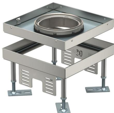
Nivellierbare quadratische Kassette für Tubus der Nenngröße 4 für den Einbau von Installationsgeräten in Kanalsystemen, Doppel- und Holzböden in trocken oder nass gepflegten Fußböden im Innenbereich. Schutzklasse: IP X5. Für den Einbau von 2 Universalträgern UT3 für 4 Einzel-Installationsgeräte mit Tragering/Tragebügel oder 6 Modul 45®-Geräte. Es können 2 Abdeckplatten APMT2 installiert werden. Der Tubus ist nicht im Lieferumfang enthalten.
