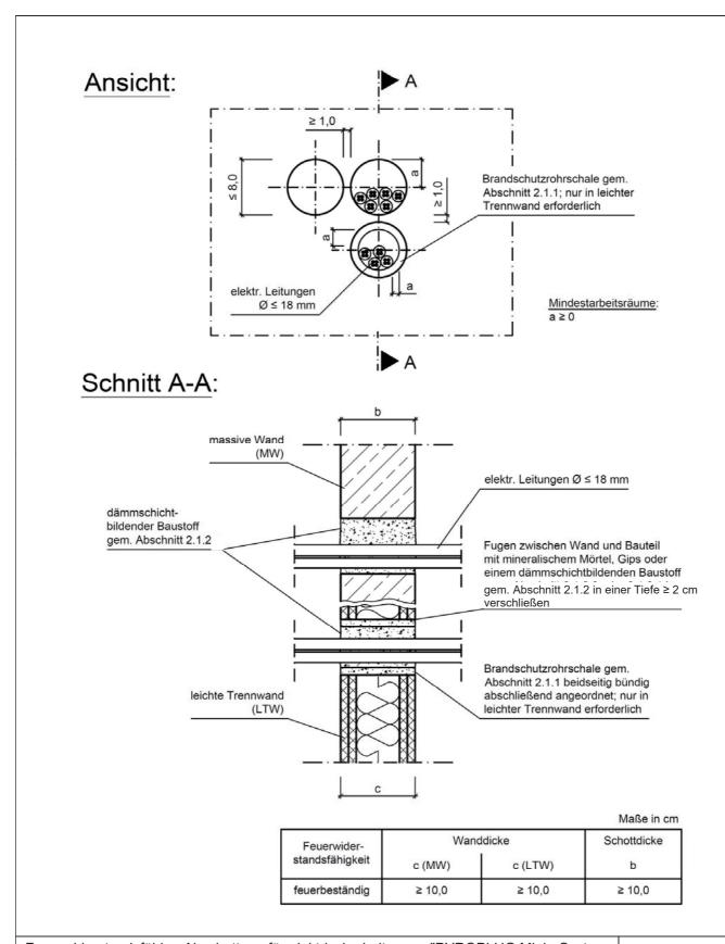
Feuerwiderstandsfähige Abschottung für elektrische Leitungen "PYROPLUG Mini - System FBA-SP"
