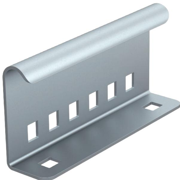
Außenverbinder zur mechanischen Verbindung von Kabelleiterstücken bei den Verlegearten mit Kabelleitern zum Funktionserhalt nach DIN 4102 Teil 12. Inklusive Schrauben.
