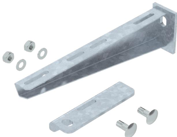
Ausleger zur Montage an Hängestielen oder als Wandausleger für die Verlegeart mit Kabelrinnen oberhalb von Brandschutzdecken und bei den Verlegearten mit Kabelleitern und Kabelrinnen für den Funktionserhalt nach DIN 4102 Teil 12. Die Ausleger werden fertig montiert geliefert.
