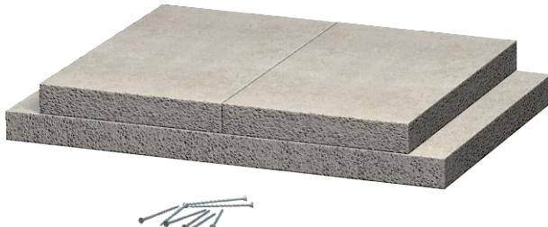
Wandanschlusskragen für BSK, bestehend aus 3 Einzelplatten, zur Aufdoppelung der Isolation bei Wanddurchführungen. Inklusive Befestigungsmaterial. Nur bei I90-Klassifizierung!
