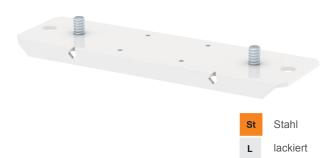
Auflager für abgehängte Montage für BSKM 0711, geeignet als Aufhängepunkt für die Aufnahme von zwei Gewindestangen M10 und als Gegenlager zur Abdichtung der Stoßstelle, inklusive Muttern
