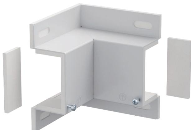
Formteil-Haube zur Abdeckung von zwei Kanalenden BSKM 0407 als Inneneck bei direkter Wand- und Deckenmontage. Inklusive eingeklebter Dichtungen zum Abdichten der Fugen und losen Dichtungen bei Kombination mit Gegenplatte, sowie Schrauben für den Potentialausgleich.
