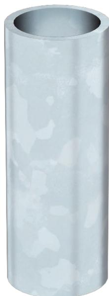
Distanzhülse zur Montage von Abhängebauteilen unter isolierten Decken; Verhindern das Eindringen der Isolierung beim Anziehen der Befestigungsschrauben. Gratarm, innen und außen verzinkt.
