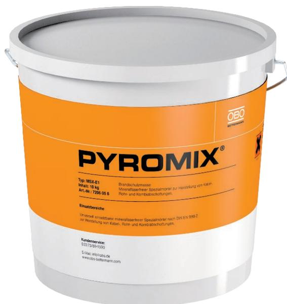
Mörtel zum Erstellen von Kabel- und Kombiabschottungen in massiven Wänden und Decken. Geeignet zum Pumpen, Pressen und zum Handeinbau. 10 kg Trockenmörtel ergeben bei Zugabe von ca. 3 Litern Wasser etwa 10 Liter verarbeitungsfähige Masse. In trockenen, kühlen aber frostfreien Räumen kann der Trockenmörtel mindestens 12 Monate in verschlossenen Originalgebinden gelagert werden.
