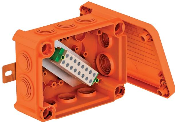
Halogenfreier Kabelabzweigkasten mit vormontierten, weichen Einsteckdichtungen, zugelassen für den elektrischen Funktionserhalt gemäß DIN 4102 Teil 12. Funktionserhaltklassen E30 bis E90.
