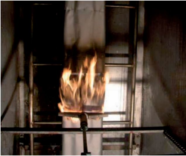
Prüfung der Kabelbandage
